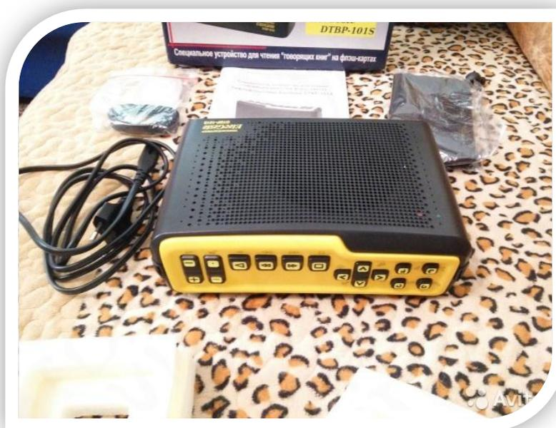
Корпус тифлофлэшплеера изготовлен из высокопрочного АВС пластика. Клавиатура управления кнопочная. Все кнопки управления снабжены звуковым сигнализатором (речевым информатором) и тактильными обозначениями. Все надписи, знаки и символы, указывающие на назначение органов управления тифлофлэшплеера, выполнены рельефно-точечным шрифтом Брайля и знаками символов.
